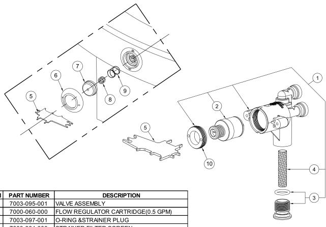
ITEM 1 2 3 4 7003-864-000 STRAINER FILTER SCREEN 5 7003-194-199 (-VR) MAINTENANCE TOOL (-VR) PUSHBUTTON ESCUTCHEON, CHROME 6 7003-197-199 (-VR) PUSHBUTTON, CHROME 7 7003-196-199 8 7003-195-000 (-VR) PUSHBUTTON OVERTRAVEL SPRING 9 7003-193-000 (-VR) PUSHBUTTON RETURN SPRING 10 7000-052-000 RETAINING NUT
